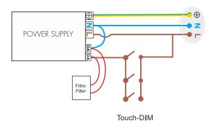
Versione dimmerabile - Collegamento con sistema di gestione Dimmable Version - Management System wiring
