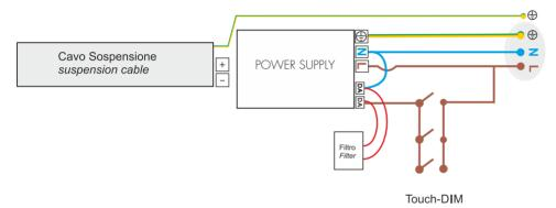
Versione dimmerabile - Collegamento con sistema di gestione Dimmable Version - Management System wiring
