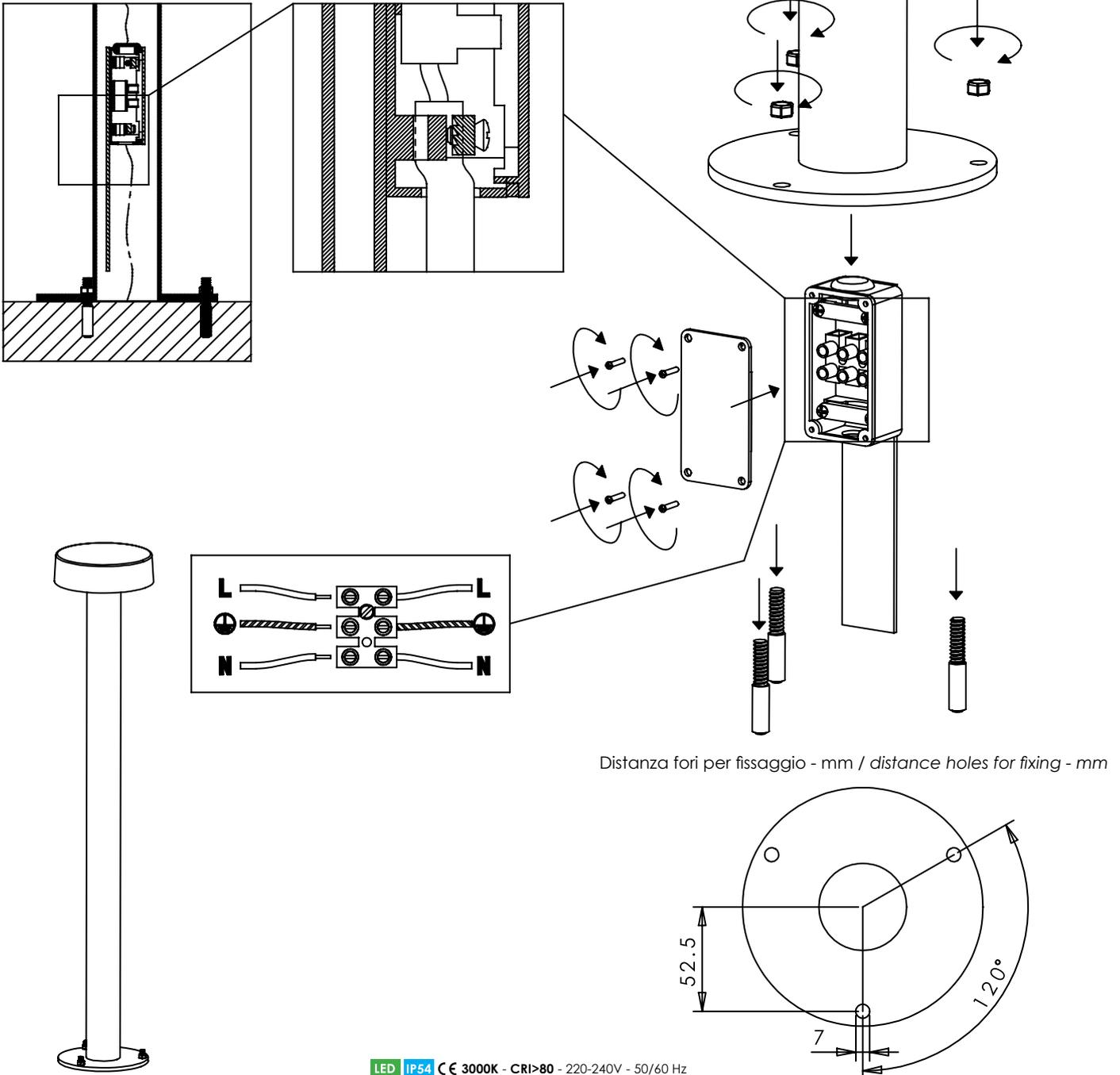
Distanza fori per fissaggio - mm / distance holes for fixing - mm
